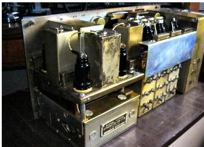
La media freq. del BC 312 è di 470 KHz, nelle gamme A,B,C, l'oscillatore lavora ad una freq. SUPERIORE DI QUELLA RICEVUTA ... A= 2900 KHz + 470 KHz, B= 4900KHz + 470KHz, C= 7850KHz + 470 KHz, mentre nelle gamme D,E,F, l'oscillatore lavora ad una freq. INFERIORE A QUELLA RICEVUTA di 470 KHz, D= 11000 KHz - 470KHz, E= 13750KHz - 470KHz, F=17750KHz - 470 KHz.
